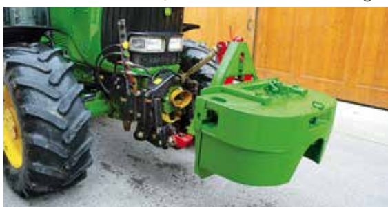
Ballastgewichte anbringen; zulässige Achsbelastung beachten.
